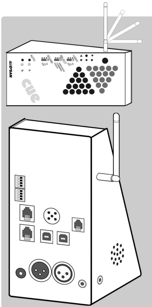
PerfectCue es un sistema de señalización luminosa y sonora. Permite al orador enviar señales al técnico de audiovisuales o activar el software de un ordenador para que responda a las órdenes de "Siguiete", "Atrás" y "Pantalla en blanco" mediante un control inalámbrico de mano.
